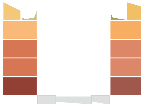
Sektion över lokalgator Längs lokalgatan finns trottoar för gående och cyklister i båda riktningarna och ett körfält i mitten
