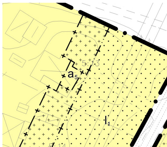
Figur 26. Utdrag i plankartan som visar bestämmelse a_5 vilken reglerar att ny bebyggelse inte får uppföras inom avgränsad del då riktvärden för elektromagnetisk strålning inte klaras.
