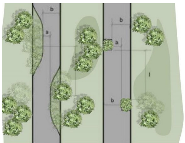
Bilden är hämtad från Trafikverkets föreskrifter om vägar och gators utformning. Den visar exempel på utformning för minskad hastighet genom planteringar, buskage eller blomlådor.
