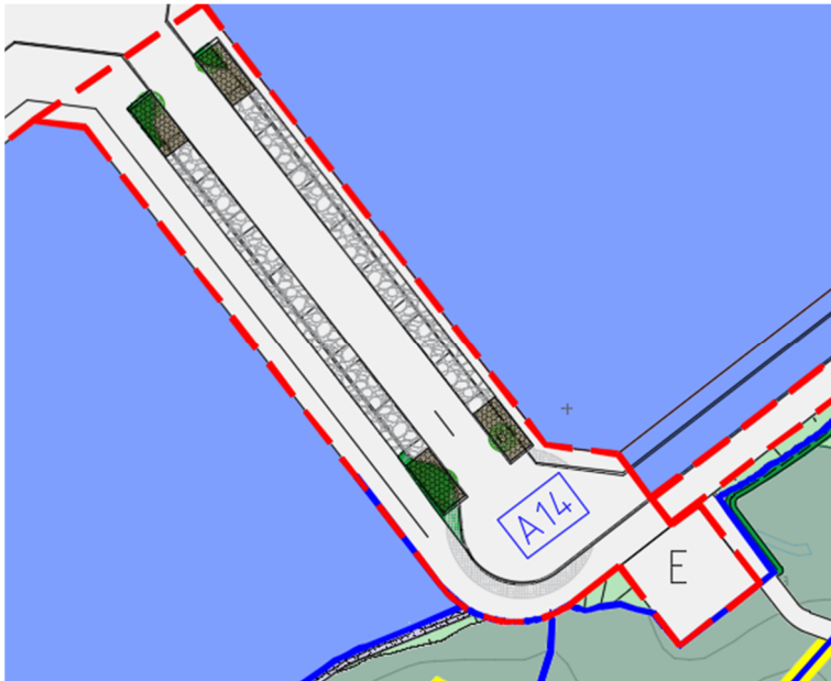
Bild 13: Område A14 (inom rödstreckad linje) omfattar Gata E, inkluderat längsgående parkeringar och gångytor samt avrinning från ytan för transformatorstation.
