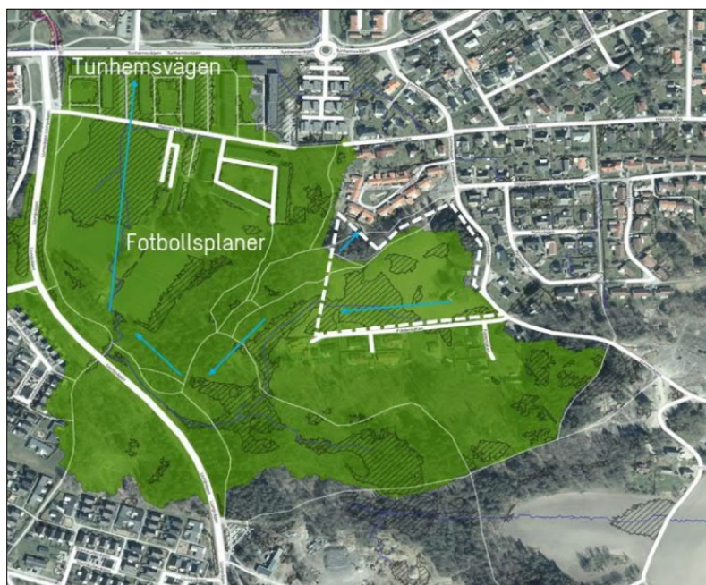
Bild 11. Från VSD-utredning: Befintligt avrinningsområde (grönt område) där planområdet ingår. Nordöstra delen av planområdet är markerat med vitstreckad linje.
