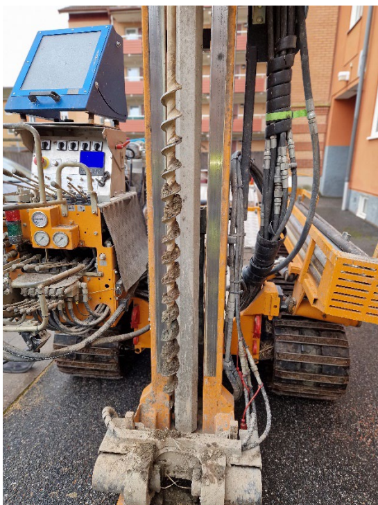
Figur 3. Jordprovtagning i punkt 2303 med skruvborr på bandvagn med markprofilen i 0-1 m djup.
