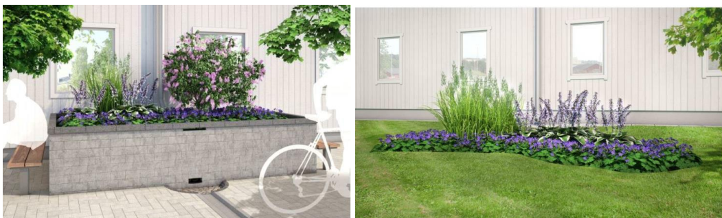
Figur 8 Vänster: Illustration av ett upphöjt biofilter (Kent Fridell & Kristian Klasson, Tengbomgruppen AB, 2014). Höger: Illustration av ett nedsänkt biofilter (Kent Fridell & Kristian Klasson, Tengbomgruppen AB, 2014).
