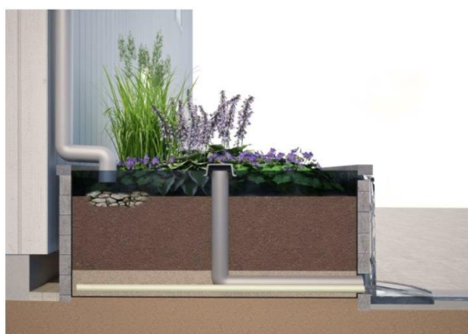
Figur 9 Biofilter med tät duk under makadamlagret och upp på sidorna (Kent Fridell & Kristian Klasson, Tengbomgruppen AB, 2014).
